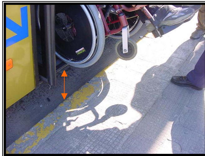
Figura 5.1 – Ônibus carroceria Caio com plataforma de acesso para deficientes que não chega ao nível da rua.
